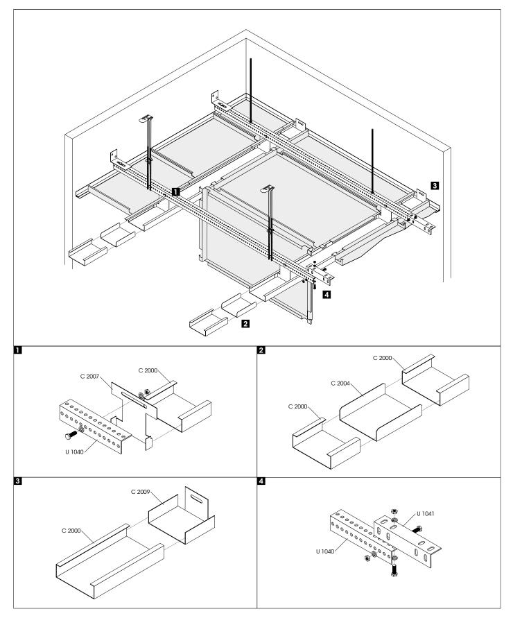
C-CHANNEL GRID SYSTEM WITH FLANGE HOOKS
